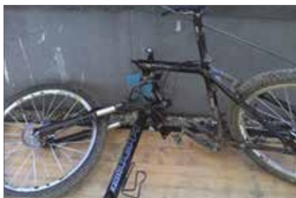
Questo è quanto potrebbe accadere ad un telaio di bicicletta in fibra di carbonio, se non si rilevano i difetti per tempo.
