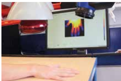
La lampada IR genera uno stimolo termico sulla pelle. La reazione di termoregolazione viene quindi registrata con la termocamera.
