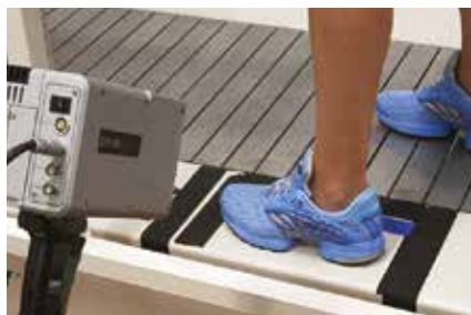
La termocamera individua i punti di calore su ClimaCool™.
