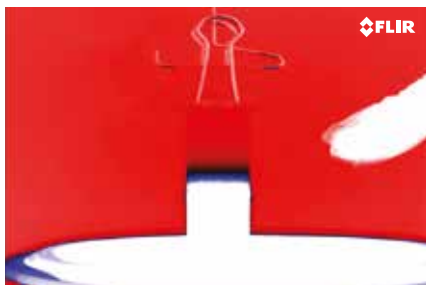
La termografia aiuta a determinare il fronte di permeazione di un liquido criogenico.
