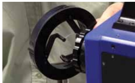
Para visualizar el CO 2 que escapa de la copa, los investigadores han utilizado un filtro externo selector de ancho de banda.
