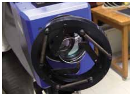
El filtro externo selector de ancho de banda se centra en el pico de emisión de CO 2 .
