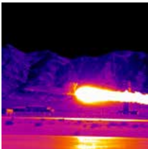
Vitesses d'intégration suffisamment rapides pour figer les images du décollage d'un F18
