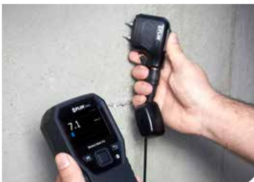
Invasive resistive Feuchtegehaltsmessungen mit dem externen Stiftsensor
