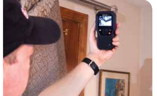
كاميرا FLIR MR160 وعمليات مسح الأسقف وفواصل الجدران للكشف عن مشكلات الرطوبة.
