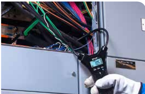
Medidor Flexível FLIR CM57 em espaços restritos
