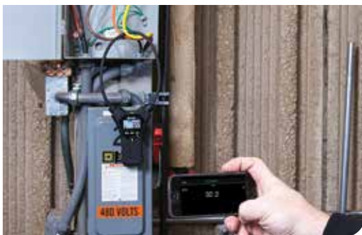
Bluetooth integrado ao CM57 para leituras a uma distância segura
