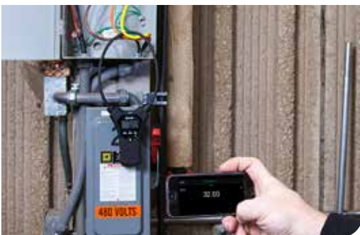
Funkcja Bluetooth urządzenia CM57 umożliwia odczyt z bezpiecznej odległości
