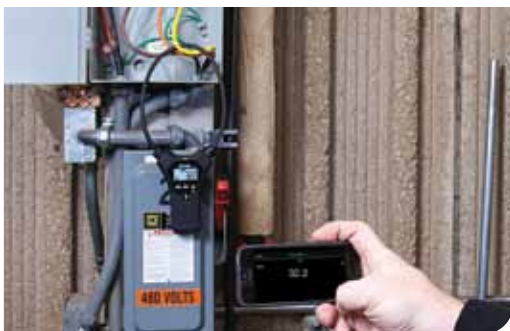
Bluetooth機能により安全な距離を保ちながら読取り値を取得
