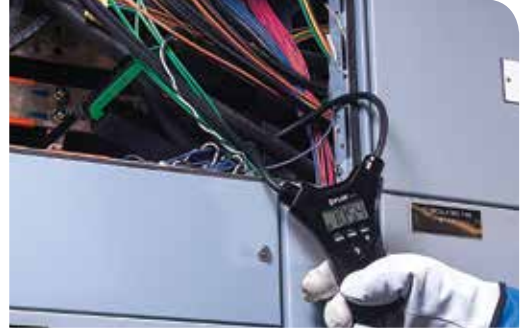
تعمل الكابلات المرنة في FLIR CM57 في الأماكن الضيقة
