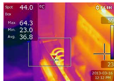
L'ispezione delle scatole dei diodi con la termocamera FLIR i7
