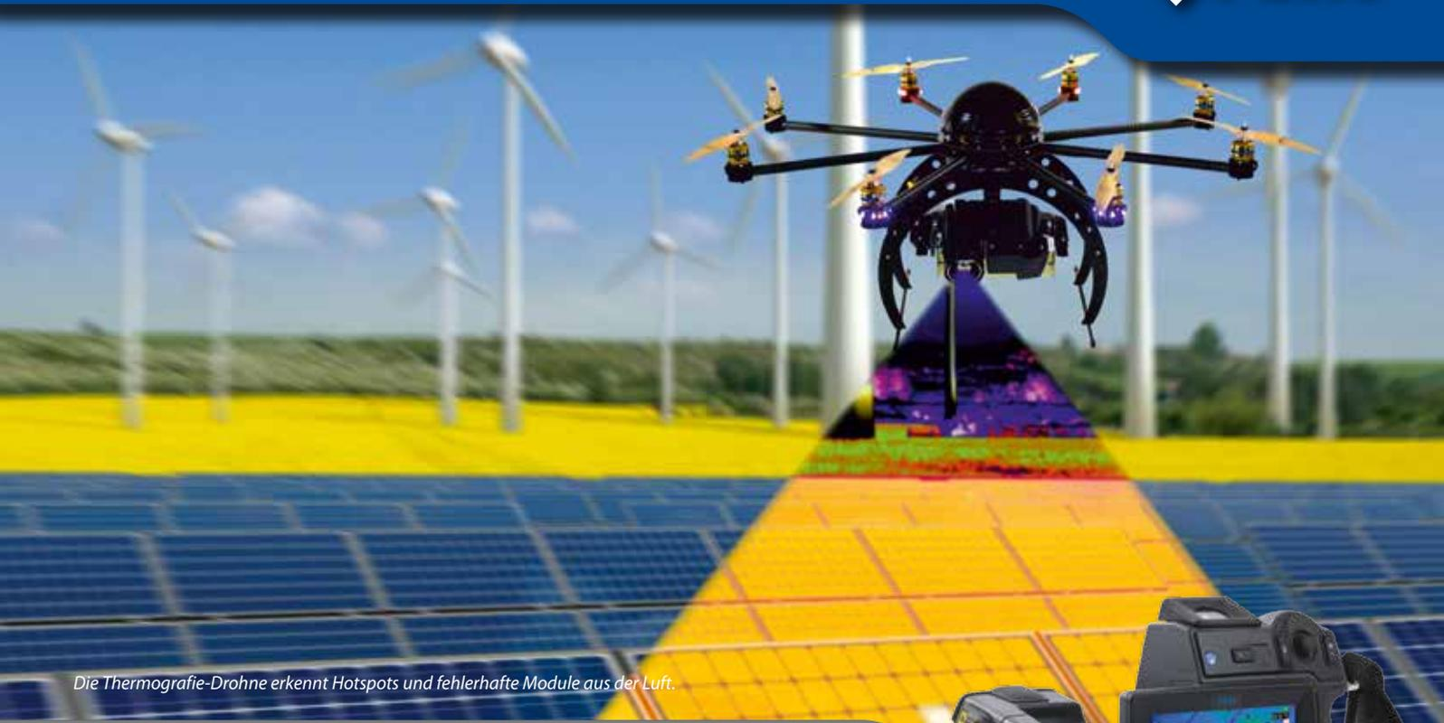
Die Thermografie-Drohne erkennt Hotspots und fehlerhafte Module aus der Luft.
