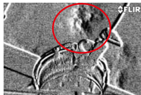
FLIR GF306を使うと、ガス漏れを容易に視認可能
