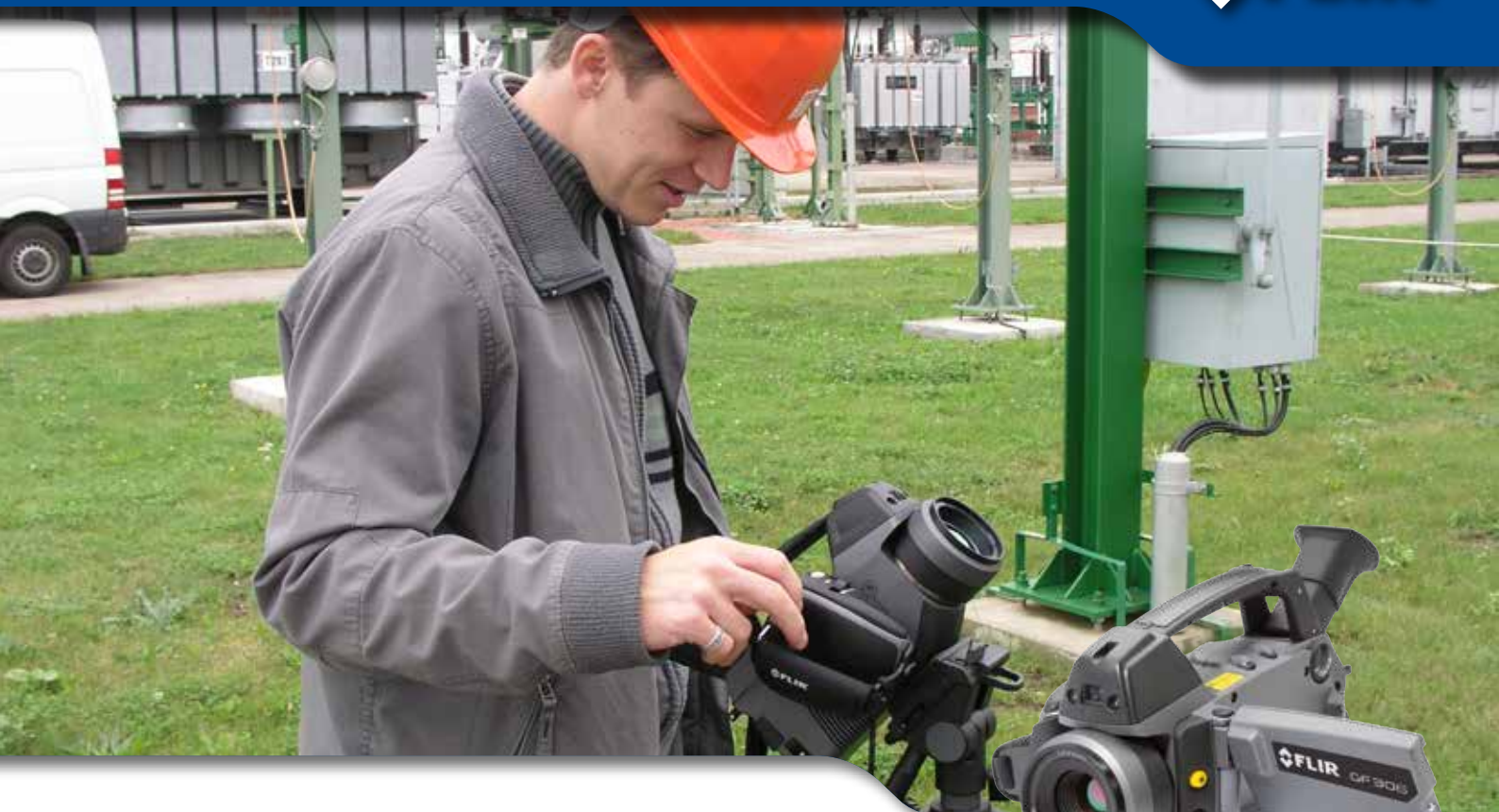
ガス検知用赤外線カメラFLIR GF306は、リアルタイムでガス漏洩を画像化
