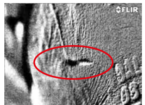
FLIR GF306を使えば、SF6を内蔵する絶縁体を安全な距離から簡単に監視できる
