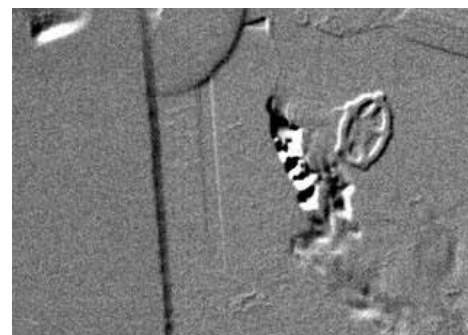
Diese im High Sensitivity Modus (HSM) gemachte Aufnahme zeigt deutlich entweichendes Gas.
