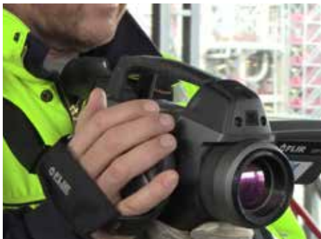
Die Gasedetektionskamera GF306 ist kompakt, relativ leicht und ergonomisch gestaltet, damit es nicht zu Rückenschmerzen und Verspannungen der Armmuskulatur kommt.
