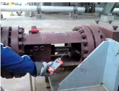
Das mit der Gasdetektionskamera lokalisierte kleine Leck wird mit einem Schnüffelgerät quantifiziert. Da die Konzentration unter dem Schwellwert liegt, wird dieser Undichtigkeit keine hohe Priorität zugeordnet.
