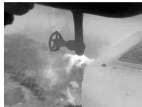
Aus diesem Ventil entweicht Ethylen. Im Wärmebild mit der Einstellung 'schwarz-heiß' ist es daher als weißer Rauch zu erkennen.
