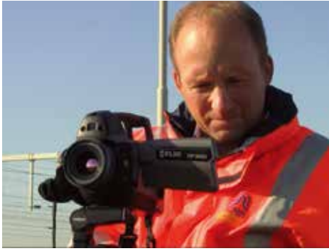
FLIR GF320ガス探知用カメラを使って検査を行うDCMRのテクニカルマネージャーRob van Doorn氏。
