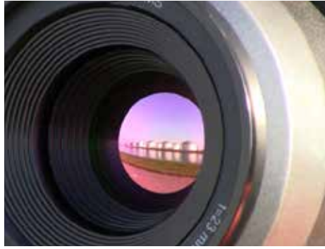
光学气体红外热像仪可从数米以外的距离检测细微泄漏，从数百米以外的距离检测大泄漏。
