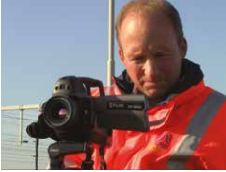
雷几蒙德DCMR环境保护署技术经理Rob van Doorn示范FLIR GF320光学气体红外热像仪的使用。
