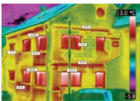
I punti caldi indicano che c'è qualcosa che non funziona nell'isolamento di quelle aree. Le immagini termiche aiutano a localizzare questi problemi in modo da essere risolti.
