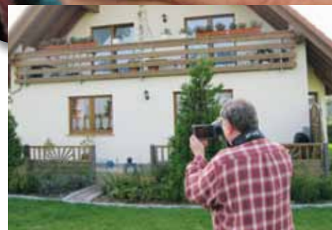
Wolfgang Böttcher offre una dimostrazione dell'utilizzo della termocamera FLIR B660 per il controllo dell'efficienza energetica
