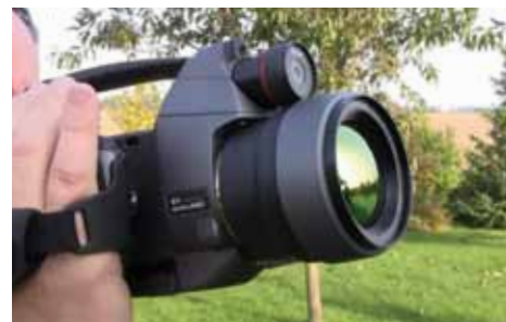
Grazie all'obiettivo da 45°, Böttcher può effettuare la scansione di un intero edificio a un paio di metri di distanza.
