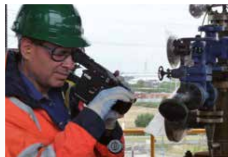
Dave Fashimpaur von BP sucht mit seiner Gasvisualisierungskameras der GF-Serie nach entweichendem Erdgas
