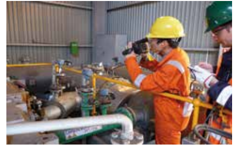
Bei beiden Aufnahmen wurde entweichendes Kohlenmonoxid mit Hilfe der FLIR GF-Kamera (aktuelle Bezeichnung FLIR GF346) entdeckt.
