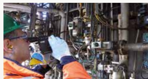
Dave Fashimpaur von BP sucht mit seiner Gasvisualisierungskameras der GF-Serie nach entweichendem Erdgas
