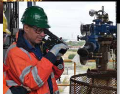
BP的Dave Fashimpaur使用GasFindIR HSX红外热像仪检测天然气泄漏
