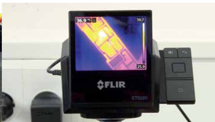
Überprüfung einer PCBA mit der FLIR ETS320 bei ISOMEDIA
