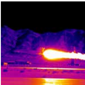
Geringe Integrationszeiten ermöglichen ein Standbild vom Start eines F18 Jets
