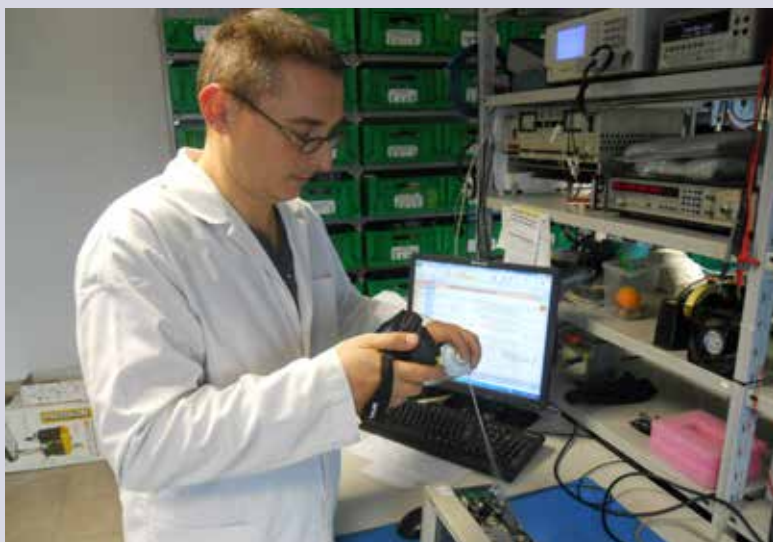
Чтобы измерить значения излучающей способности интегральной схемы, на нее можно нанести покрытие.
