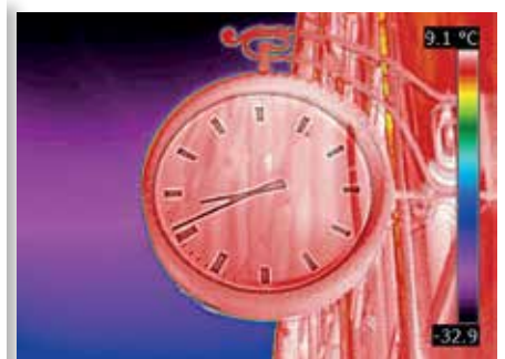
Värmebild med MSX. Observera att fler detaljer är synliga.
