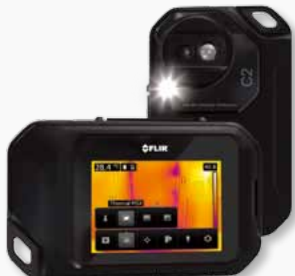
MSXを適用した熱画像は詳細情報がはっきり見える
