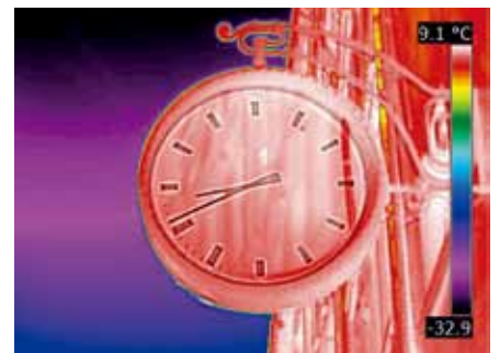
MSXを適用した熱画像は詳細情報がはっきり見える
