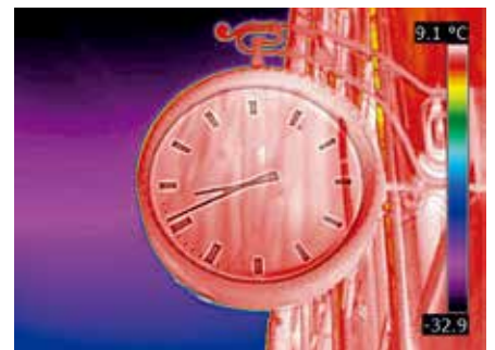
使用MSX多波段动态成像功能的热图像。注意：可以发现更多的细节。
