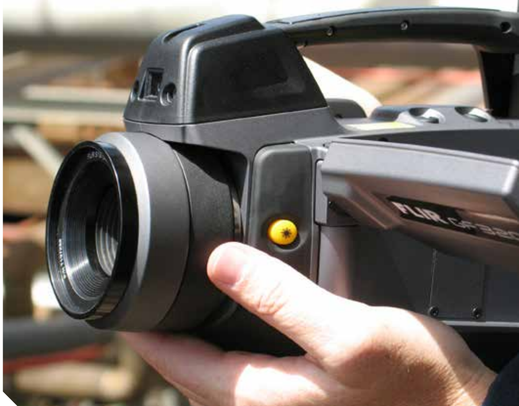
Termocamera per la rilevazione ottica di gas FLIR GF320
