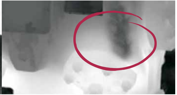
Fuga de gas capturada
