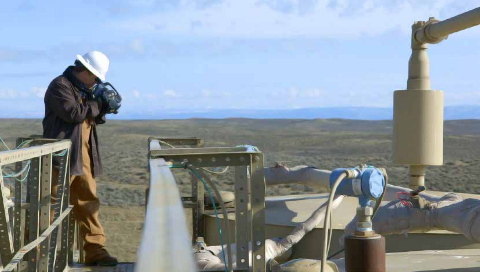
Optische Gas-Kameras können Bereiche scannen, die sich mit TVAs unmöglich erreichen lassen.
