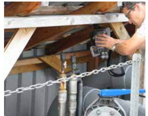
Diplomingenieur Ibeling van Lessen bei der Suche nach Gaslecks, die mit der FLIR GF320 auch aus sicherer Entfernung und ungewöhnlichen Winkeln möglich ist.
