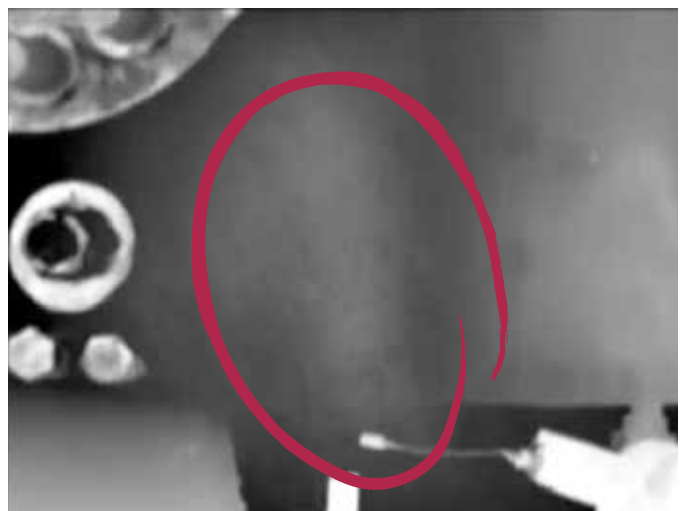
Uno sniffer deve essere puntato nel luogo esatto della perdita per rilevare la fuga di gas. Le termocamere OGI (Optical Gas Imaging - rilevazione ottica di gas) possono rilevare fughe di gas in qualsiasi punto del proprio campo visivo
