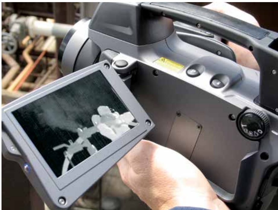
Le termocamere per la rilevazione ottica di gas consentono di rilevare anche le più piccole perdite, mantenendosi a distanza di sicurezza.
