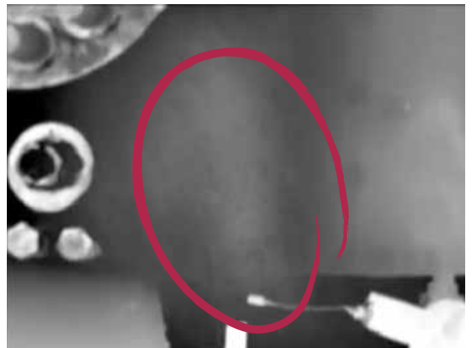
Mit dem "Sniffer" erkennt man das Leck nur wenn man ihn gerade zufällig genau davor oder dicht daneben hält. Gasdetektionskameras erkennen innerhalb ihres Sichtfelds alle vorhandenen Gaslecks
