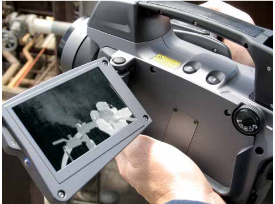
Mit einer Gasdetektionskamera können Sie selbst kleinste Lecks aus sicherer Entfernung erkennen und lokalisieren.
