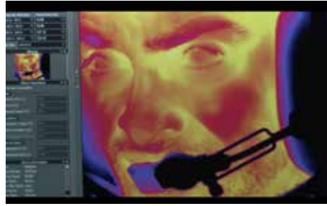
Die Wärmebildkamera des ISMS überwacht die Gesichtstemperaturmodulation der Crew, während diese typische Pilotenaufgaben ausführt.
