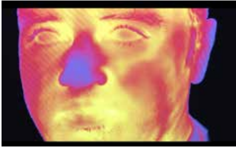
Die Wärmebildkamera des ISMS überwacht die Gesichtstemperaturmodulation der Crew, während diese typische Pilotenaufgaben ausführt.
