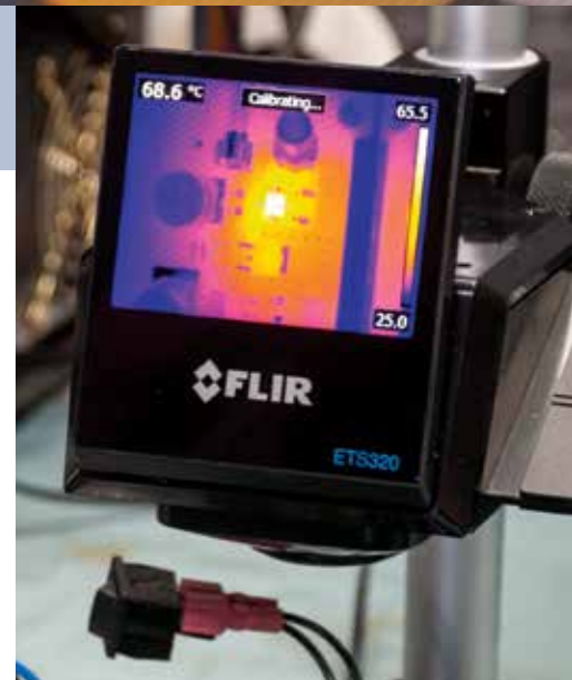
Mit 76.800 berührungsfreien Messpunkten und einer thermischen Empfindlichkeit von <0,06\text{ °C} hilft die FLIR ETS320 den Ingenieuren beim raschen Erkennen von Konstruktionsfehlern.
