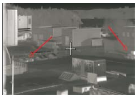
図4: 標準のAGCアルゴリズムが適用されたコントラストの高いシーン
