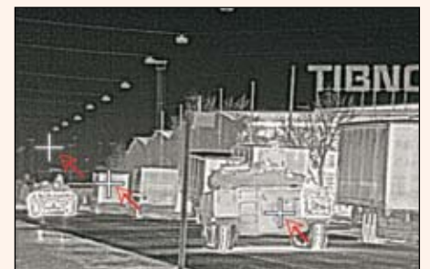
図10:DDE - コントラストの高低にかかわらずターゲットを同時表示
