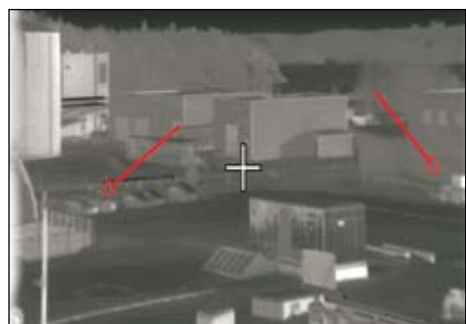
Bild 4: Szene mit hohem Kontrast bei Anwendung des standardmäßigen AGC-Algorithmus
