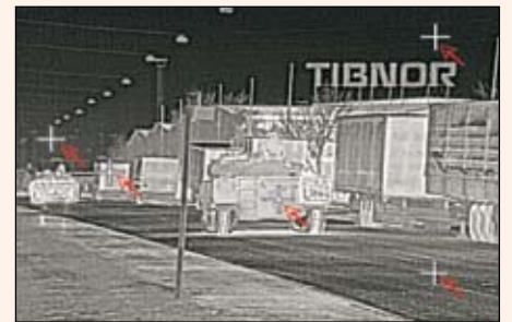
Bild 10: DDE – Ziele mit hohem und niedrigem Kontrast können gleichzeitig beobachtet werden
