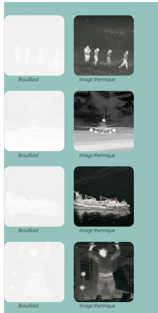
La vision à travers le brouillard est utile à de nombreuses applications. Les applications maritimes, de sécurité, de l'automobile et de l'aéronautique peuvent toutes bénéficier de la puissance de l'imagerie thermique et de sa capacité à voir plus loin dans le brouillard qu'à l'œil nu ou qu'avec une caméra CCTV.
