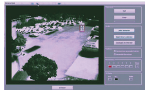
Die eingesetzte Videoanalyse wurde ganz speziell abgestimmt auf die Wärmebildkamertechnik: Wenn sich Personen dem geschützten Bereich nähern, wird ein Alarm ausgelöst.
