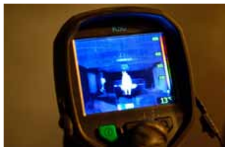
K50 열화상 카메라는 화재현장을 파악하고 생존자를 찾아 구조할 수 있도록 목적에 따라 최적화된 몇 가지 동작 모드를 지원합니다.
