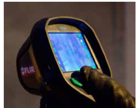
Die FLIR K-Serie lässt sich mit nur 3 großen Tasten oben auf der Kamera bedienen. Das ist optimal für Feuerwehrleute, die mit Handschuhen arbeiten.
