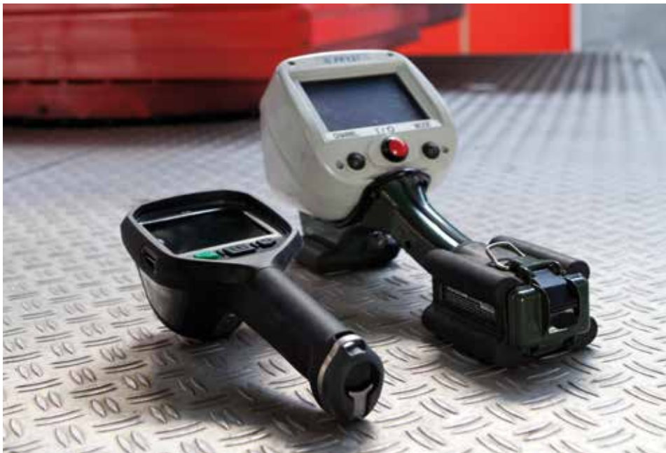
FLIR K50 ao lado do FireFLIR. Embora o FLIR K50 seja preferível por ser mais compacto, o FireFLIR ainda demonstra seu valor, sendo utilizado mesmo após 10 anos no mercado. Foi amplamente utilizado durante o incêndio no Urzal de Kalmthout em 2011.
