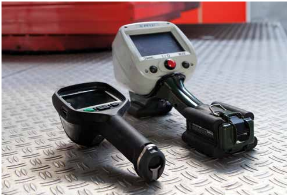
FLIR K50 和 FireFLIR 红外热像仪。虽然FLIR K50凭借其小巧的机身成为首选工具，但10年来FireFLIR依然在役。尤其在卡尔姆特蒙特荒原2011年的大火中发挥了重要作用。
