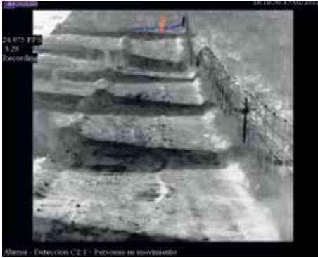
Alle menschlichen Ziele werden automatisch erkannt und verfolgt. Sobald diese den virtuellen Zaun überqueren, wird ein Alarm ausgelöst.
