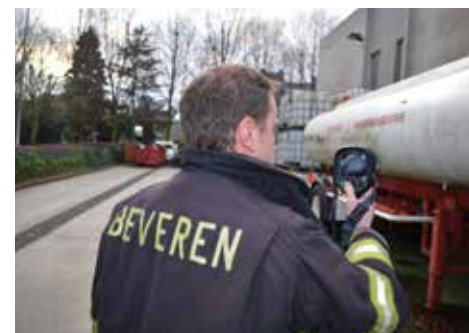
Com o FLIR K50, pode-se visualizar variações de temperatura resultantes de todo tipo de reação química, o que é fundamental para o corpo de bombeiros de Beveren, devido às muitas indústrias químicas localizadas no porto de Waasland.
