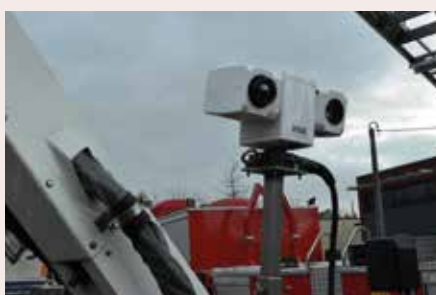
O corpo de bombeiros de Beveren utiliza um sistema PTZ com visor e uma câmera térmica para monitorar incêndios.
