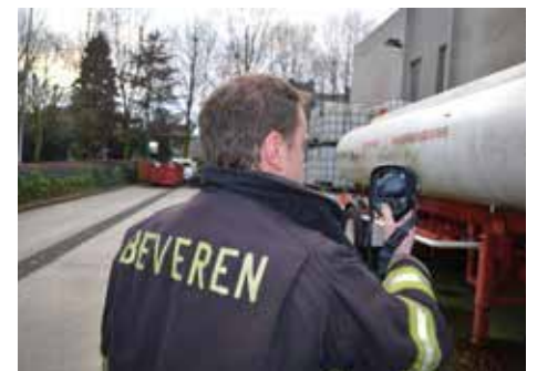
FLIR K50 열화상 카메라는 용기 속에 있는 각종 화학물질이 반응을 일으켜 온도가 변화하는 것을 탐지할 수 있습니다. 이것은 화학공장이 많은 이 지역 소방관들에게 큰 도움이 되는 것입니다.
