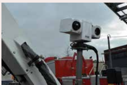
Il dipartimento dei Vigili del Fuoco di Beveren utilizza un sistema PTZ con una fotocamera e una termocamera FLIR per monitorare gli incendi.
