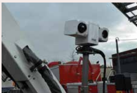
Les pompiers de Beveren utilisent un système PTZ avec une caméra pour la lumière visible et une caméra thermique FLIR, pour évaluer la situation lors des incendies.
