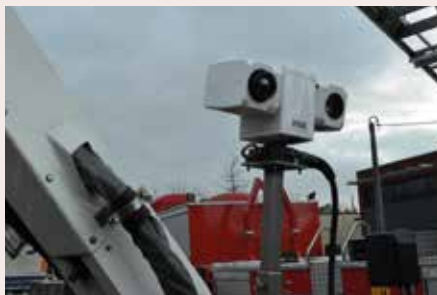
El cuerpo de bomberos de Beveren utiliza un sistema PTZ con una cámara visual y una cámara térmica FLIR para controlar incendios.
