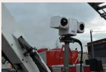
Die Feuerwehr Beveren setzt ein PTZ-System mit einer Tageslicht- und einer Wärmebildkamera von FLIR ein, um Brandsituationen zu überwachen.
