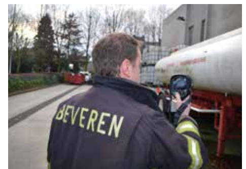
您可以使用FLIR K50观察到容器内因发生各种化学反应引起的温度变化，这对于比华伦消防部门来说非常实用，因为在华斯兰德港是化工企业密集区。
