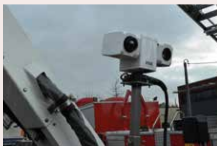
比华伦消防部门使用由一台可见光相机和一部红外热像仪组成的PTZ系统监控火情
