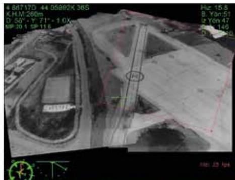
在无人机飞行过程中或红外热像仪转变方向时，使用马赛克软件对图像进行补充，使之连贯，从而提供更加全面的环境感知。
